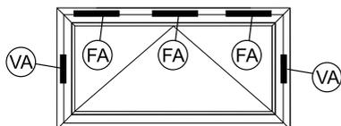
FA Оконный привод (E 9x0 L/R, E 250 NT, Slimchain, Powerchain)
