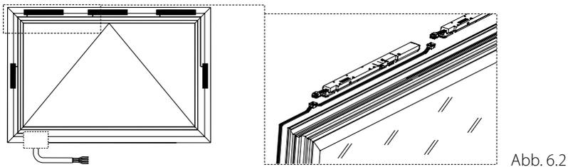
Nach Abschluss der Arbeiten am Fenster müssen alle Antriebe in Reihe mit der Anschlussdose bzw. dem Kabelübergang verbunden sein.
