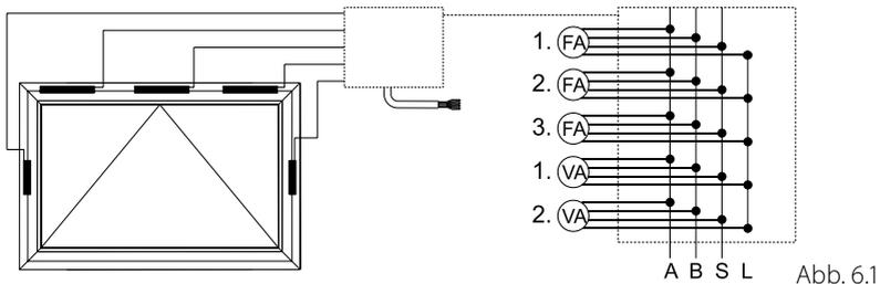
Zum Anschluss der integrierten Antriebe E 90x und E 9x0 L/R ist es erforderlich, diese vor der Montage am Fenster zu verkabeln.
