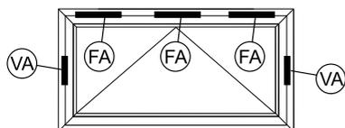
FA Entraînement de fenêtre (E 9x0 L/R, E 250 NT, Slimchain, Powerchain)
